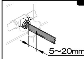
配管は取付穴中心に設置し、
