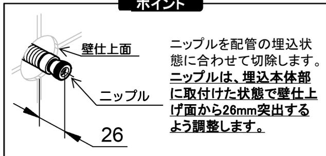
1. 壁仕上げ面から埋込本体の距離を測定します。
