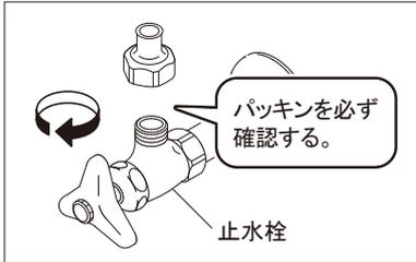
②ジョイント金具にパッキンが付いているのをご確認のうえ、止水栓に「レンチ」などでしっかりと締付けます。
