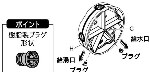
3. フラッシングインサートを取付け、固定ねじを締めつけます。
