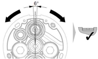
3. 残り2箇所の長穴にねじ止めし、ウォーターガイドを固定します。
