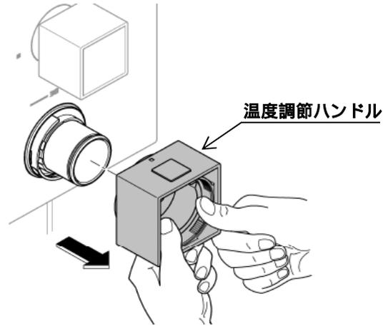
4. 温度調節リング内部に温度リミッターを取付けます。最高吐水温度の設定は以下の3種類からお選び頂きます。
