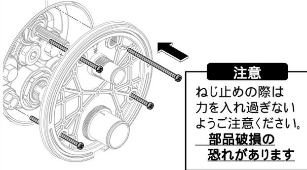
2. 開閉ストッピングと温調ストッピングをマウントプレートに取付けます。
