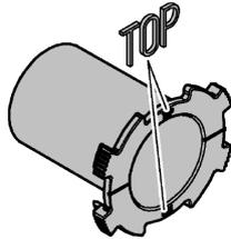
7. 開閉ハンドルに抜け止めリングを挿入します。
