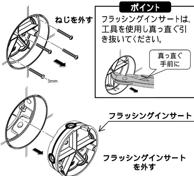
2. フラッシングインサートの給湯・給水穴の樹脂製プラグを取外します。(ペンチやプライヤー等の工具を使用してください)
