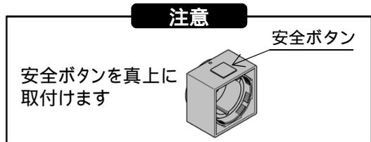
5. 化粧プレート、温調ハンドルを取付け、温調ハンドルに抜け止めストッパーを取付けます。
