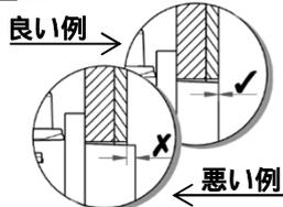
4. 埋込本体部と壁の隙間を、コーキング材で埋めます。
