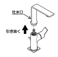
**3.** 吐水口裏側接続部にストッパーが付いています。 製品出荷時は100°回転用ストッパーです。
