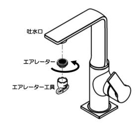
清掃後は確実にエアレーターを取付けてください。 きちんとねじ山に沿って組付けしなければ、水漏れ やエアレーターを破損させてしまうことがあります。
