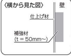
※補強材の両端は柱、間柱など構造体に確実に固定してください。
