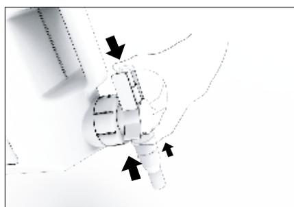
3. 燃料注入は両手で行ってください。片手の手のひらをノズル上部に、その親指は緑色のボタンに置いてください。もう片方の手で燃料缶を垂直に傾け、しっかり押さえてください。緑色のボタンを押して、燃料を注ぎます。注入を止めるには緑色のボタンを離します。
