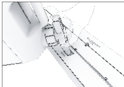
XL900/XL700: パネ式キャップが搭載されており、注入を始めるまでは燃料缶注ぎ口が完全に閉まったままになる仕組みとなっています。これにより、燃料のスピード注入が可能になり、注入中の液はねも防止されます。
