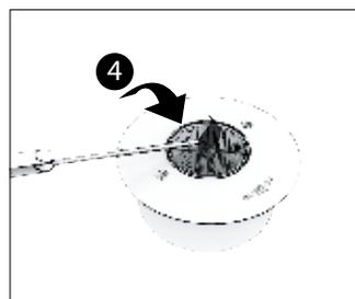
1. 蓋を開けて燃焼室に着火補助棒の先端を浸して、燃料で湿らせませす。
