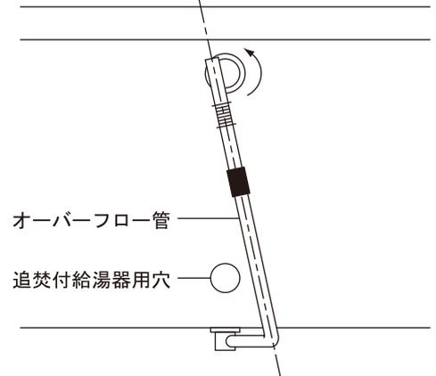
※追焚付給湯器対応モデルの場合、排水金具のオーバーフロー管を図のように斜めに取付けることにより、追焚付給湯器循環金具に干渉せずに取付可能です。
