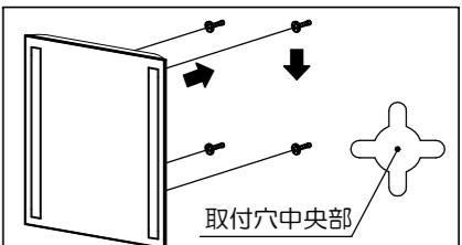
①-4 スタット金具の取付穴中央部に壁のねじ頭が入るように差し込み、下に落とし込んで引っかけてください。コンセントにプラグを差し込みます。
