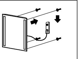
②-5 スタット金具の取付穴中央部に壁のねじ頭が入るように差し込み、下に落とし込んで引っかけてください。
