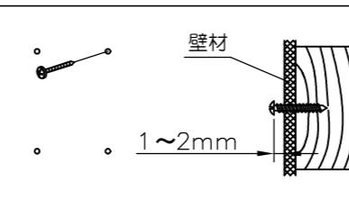
①-2 印をつけた位置に付属の取付ねじ(4本)をねじ込んでください。取付ねじは1~2mm壁から開けた状態まで差し込みます。
