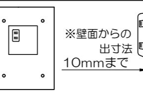
②-2 取付ゲージにあけた穴にコンセントをおさめて取付位置に印をつけます。印をつけた位置に取付ねじをねじ込みます。①-2参照
