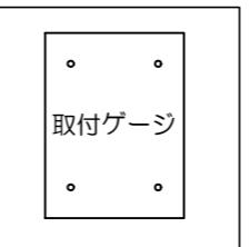
①-1 付属の取付ゲージを使って取付位置をきめて印をつけます。
