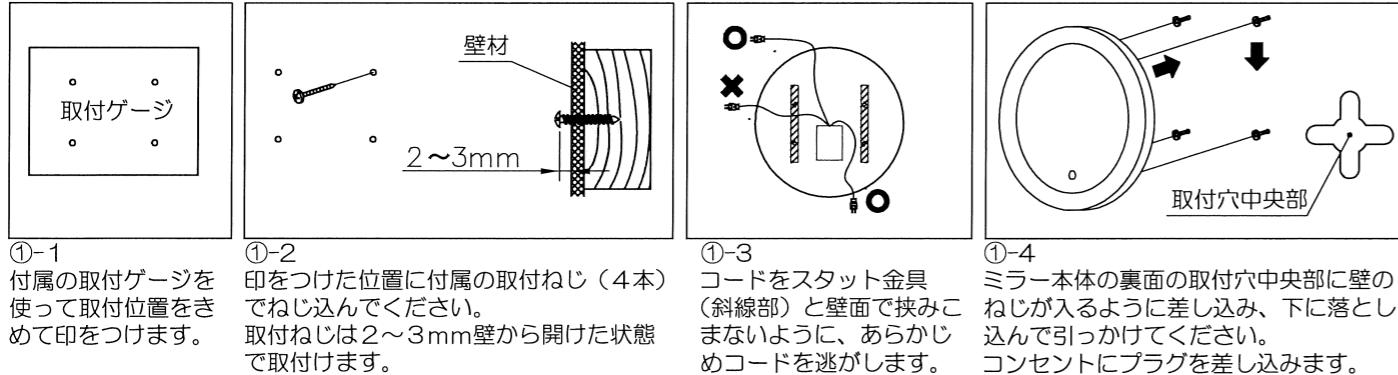
①-1 付属の取付ゲージを使って取付位置をきめて印をつけます。
