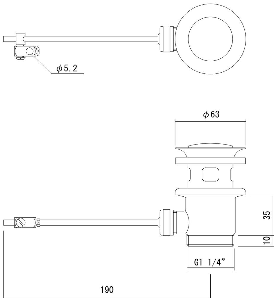
※連結する際、洗面器によっては水栓側引棒の先端部分を少し曲げて接続する必要があります。
