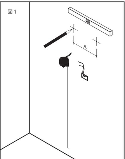
1. それぞれの製品寸法図を参考に、壁面の取付位置に印をつけます。
