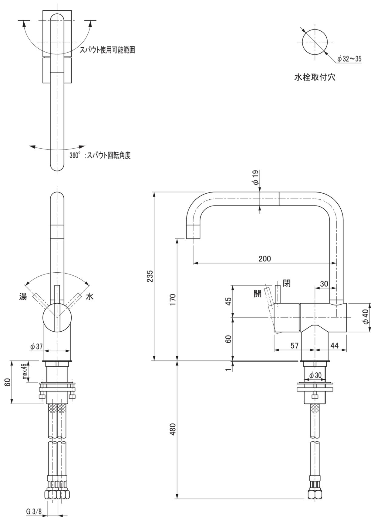
設置条件:ハンドルを正面(シンク及び洗面器側)に向けた状態で設置してください。
