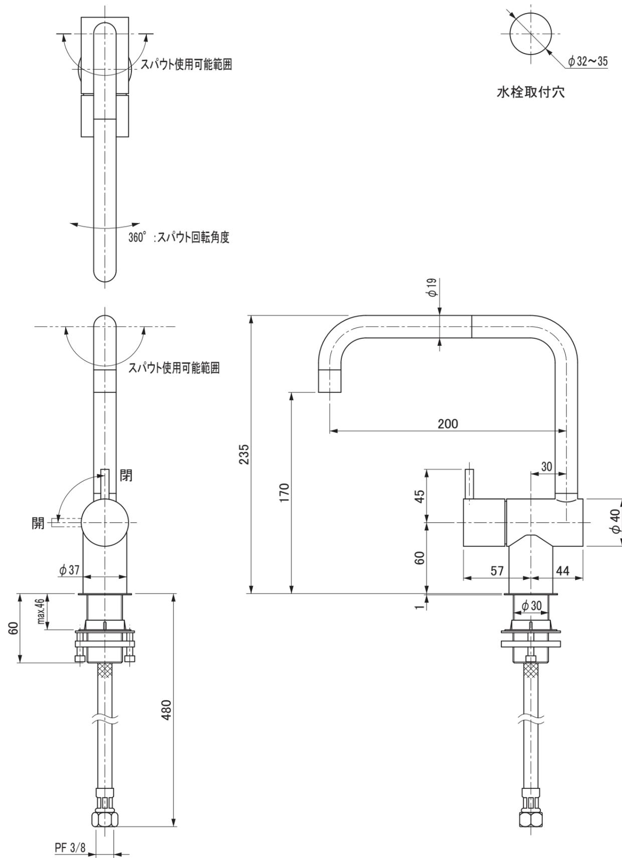
設置条件:ハンドルを正面(シンク及び洗面器側)に向けた状態で設置してください。
