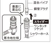
②ワンタッチソケットのスライダーを下げている状態で、銅管プラグに 音がする(スライダーが自動的に上がる)まで垂直に差込みます。 \*ワンタッチソケットを外すときは、スライダーを下げながら下方に
