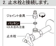
①ジョイント金具にパッキンをはめ込み、止水栓にしっかりと締付けます。
