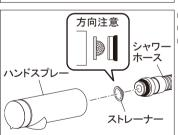
②ハンドスプレーとシャワーホースの間にあるストレーナーを取外します。 ③ストレーナーの網目に付いたゴミなどの異物を、水洗いして取除きます。 ④①~②の逆の手順で元に戻します。
