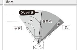
ハンドルを開いた状態で 手前から中心部までは「水」が出ます。 さらに奥側にまわすと次第に「湯」が出始めます。 \*水・混合水の切替時、クリック感があります。
