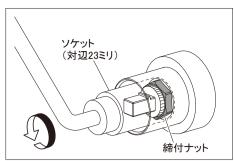
⑤ソケット(対辺23ミリ)で、締付ナットを左にまわしてゆるめ、 古いカートリッジと一緒に締付ナットを取外します。
