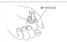
⑥新しいカートリッジの底にベースパッキンが付いている のを確認してから、底の凸部が混合栓本体の凹部に合う ように差込みます。
