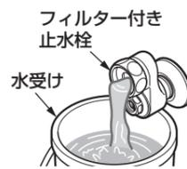
バケツなど水受けとなるものを準備し、壁や床に水が飛び散らないよう止水栓をゆっくり開き、給水・給湯管内のごみ、砂などを洗い流す。
